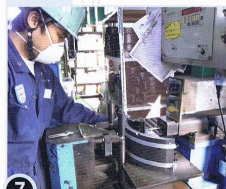
油圧式リベッターによる リベット打ち付け作業
