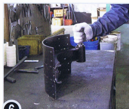
アンカーピンのガタつき、 コアの歪み確認作業
